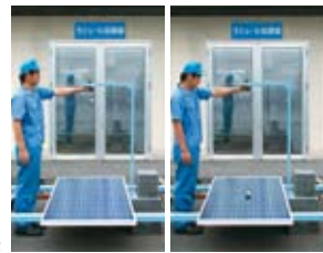
1) Comprobación de la capacidad de carga estática 2) Comprobación de la resistencia al impacto
